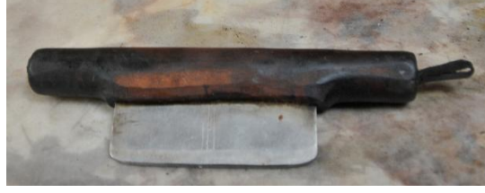
Fotoğraf 5. Derilerin arkasındaki et ve yağları sıyırmak için kullanılan bıçak
