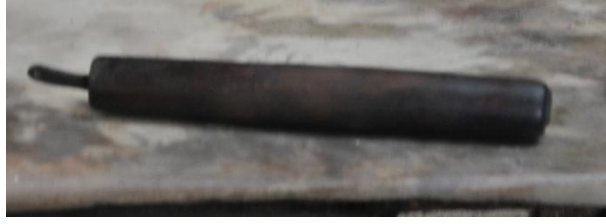
Fotoğraf 8. Derileri açmada kullanılan demir silindir aleti
